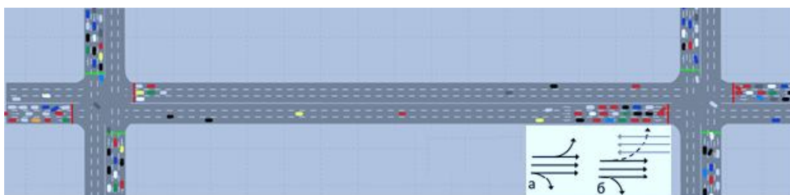
Рисунок 2 — Рассмотренные варианты фаз регулирования, обслуживающих транспортный поток на замыкающем трехполосный сегмент пересечении (PTV Vissim): а — без конфликта левоповоротного движения с прямым потоком; б — с конфликтом движения левоповоротного потока
