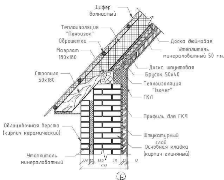
Рисунок 1 — Чертеж карнизного узла
