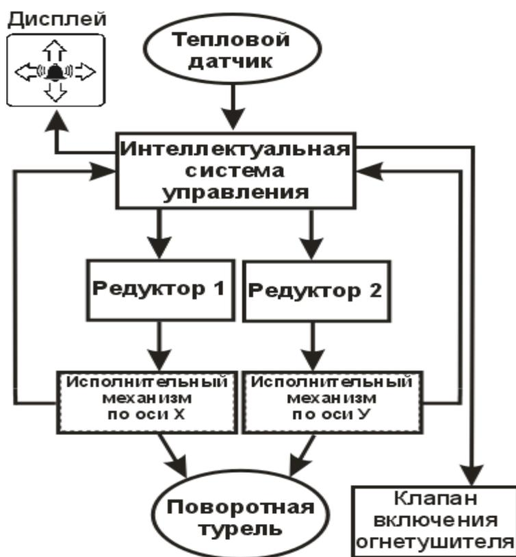
Рисунок — Блок-схема управления средством пожаротушения
