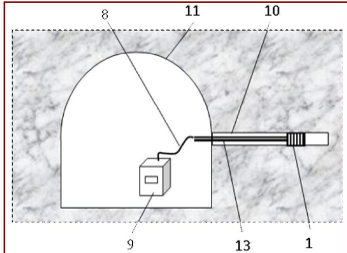
**Назначение.** Интроскоп предназначен для определения структурных неоднородностей в массиве горных пород (трещин, слоевых контактов и др.) путём измерения изменений диэлектрической проницаемости массива вокруг скважин.
