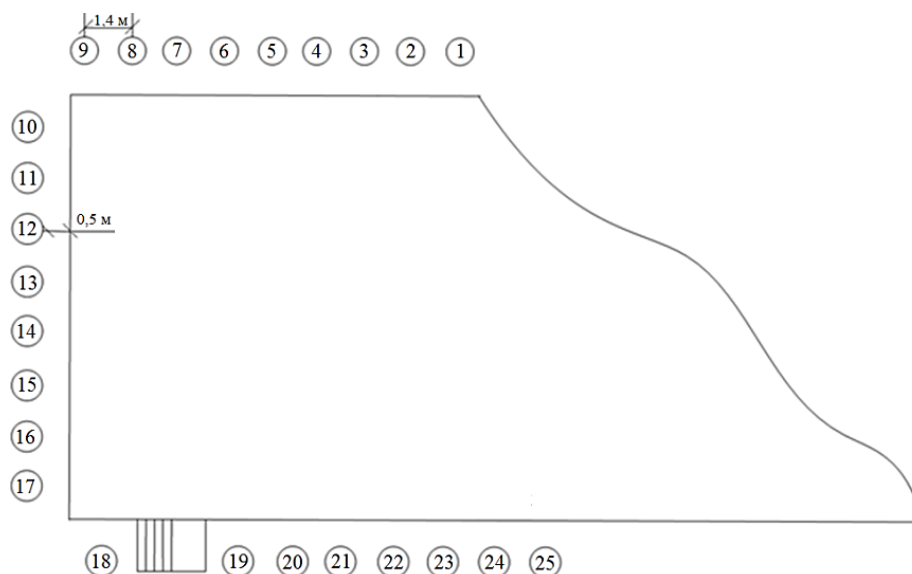
Рисунок 4.18 — Исполнительная схема расположения инъекционных скважин
